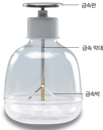
▶그림 11 검전기의 구조 검전기는 금속판이 달린 금속 막대의 끝에 얇고 가벼운 금속박 두 장을 붙여 유리병 안에 넣은 것이다.
