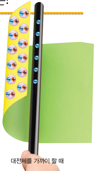
▶그림 10 부도체에서의 정전기 유도
