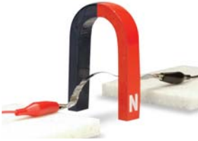
그림 50 알루미늄박이 받는 힘 알루미늄박이 위로 힘을 받아 휘어진다.
