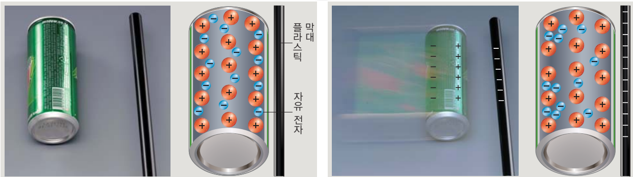
그림 8 자유 전자의 이동과 정전기 유도 대전된 플라스틱 막대를 알루미늄 강통에 가까이 하면 알루미늄 강통 속의 자유 전자들이 이동하여 알루미늄 강통이 전기를 띠게 된다.
