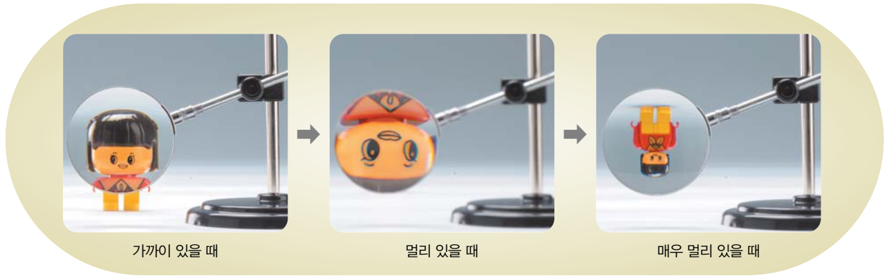
❶ 그림 25 볼록렌즈에 의한 상 물체에서 볼록렌즈까지의 거리에 따라 상의 크기와 서 있는 모습이 달라진다.
