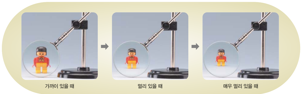
❷ 그림 26 오목렌즈에 의한 상 물체보다 작은 상이 똑바로 생긴다.
