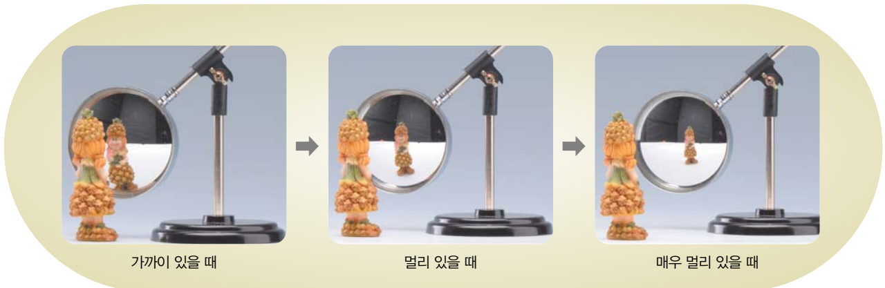
● 그림 15 볼록거울에 의한 상 볼록거울에서 물체까지의 거리가 멀수록 상의 크기는 작아진다.
