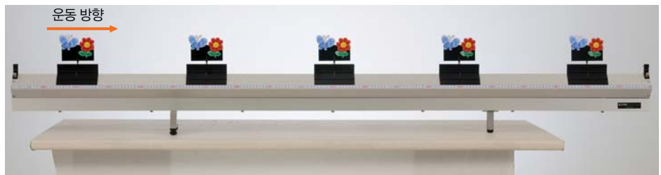
그림 39 에어 트랙에 공기가 나올 때 일정한 시간 간격으로 사진을 찍으면 물체 사이의 간격이 일정하다.
