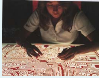
◀ 그림 65_ 회로 도면 설계 컴퓨터 시스템을 이용하여 전자 회로 도면을 설계한 후, 이상 여부를 정밀하게 검사한다. 이 회로를 실리콘 기판에 새겨 넣어 실리콘 칩을 만든다.
