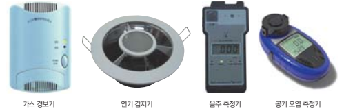
▲ 그림 22. 가스 센서를 이용하는 기기
