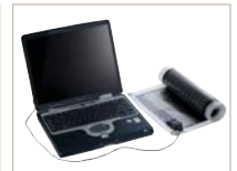
휘는 태양 전자 전도성 고분자를 이용하여 만든 태양 전지는 가볍고, 구부릴 수 있어 휴대가 간편하다.
