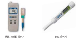
▲ 그림 23. 이온 센서를 이용하는 기기
