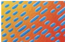
▲ 그림 51_ 전자 현미경으로 관찰한 CD 표면
