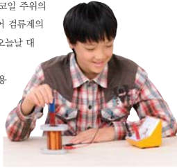
▲ 그림 30 _ 자기장의 변화와 전류의 발생 코일 주위의 자기장이 변화하면, 코일에 전류가 유도된다.
