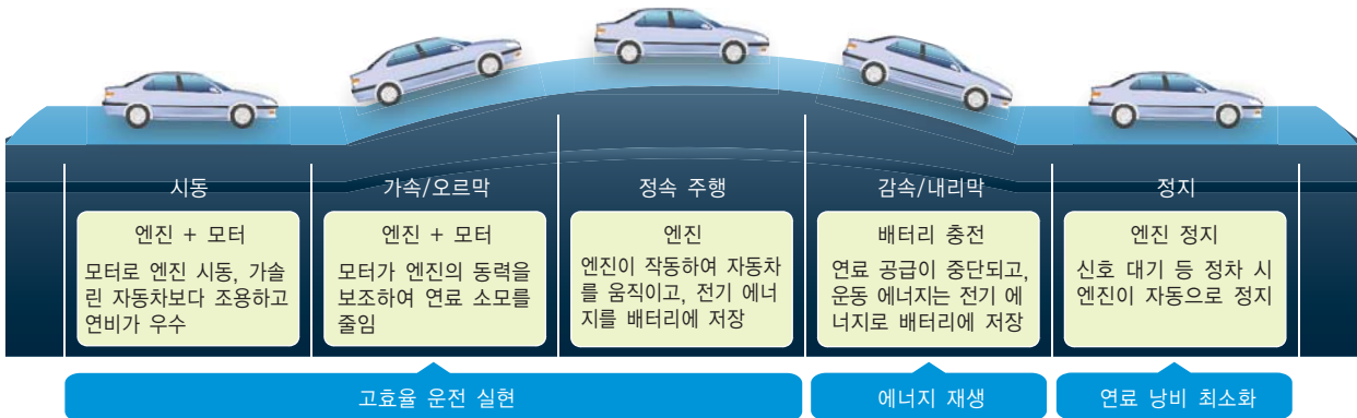
▲ 그림 105 _ 하이브리드 자동차의 원리
