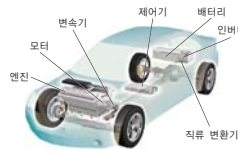
▲ 그림 104_ 하이브리드 자동차의 구조
